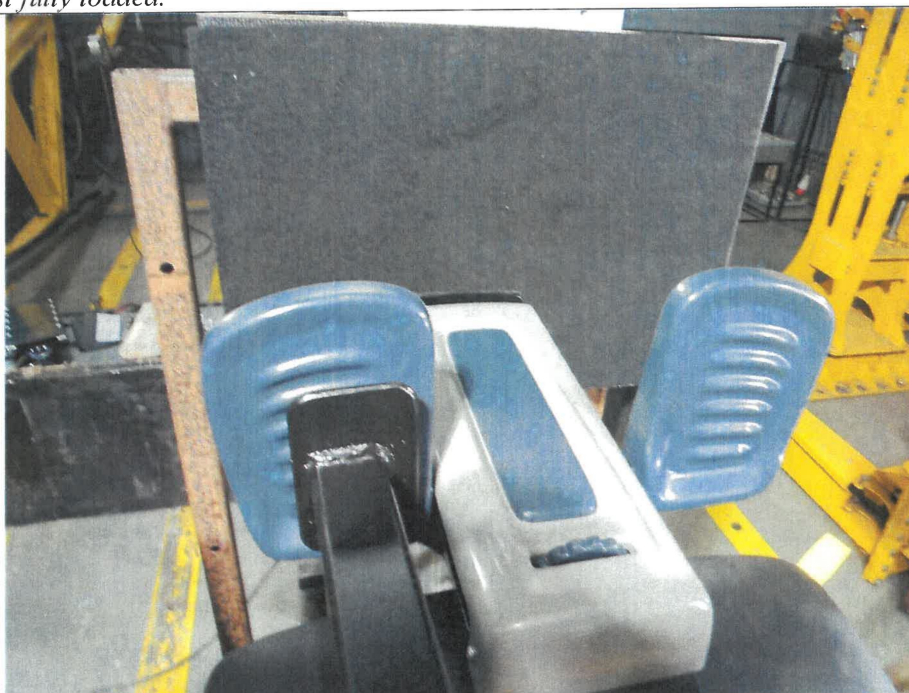
Zdj. 3. Podnóżek obciążony niesymetrycznie. Pic. 3. Footrest asymmetrically loaded.
