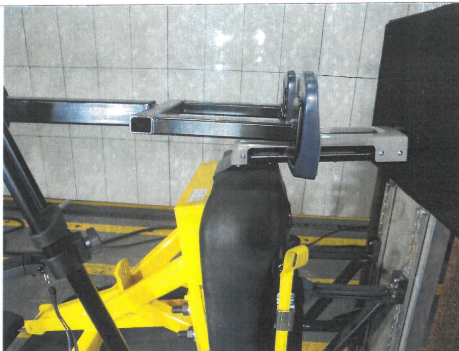
Zdj. 2. Podnóżek obciążony całościowo. Pic. 2. Footrest fully loaded.
