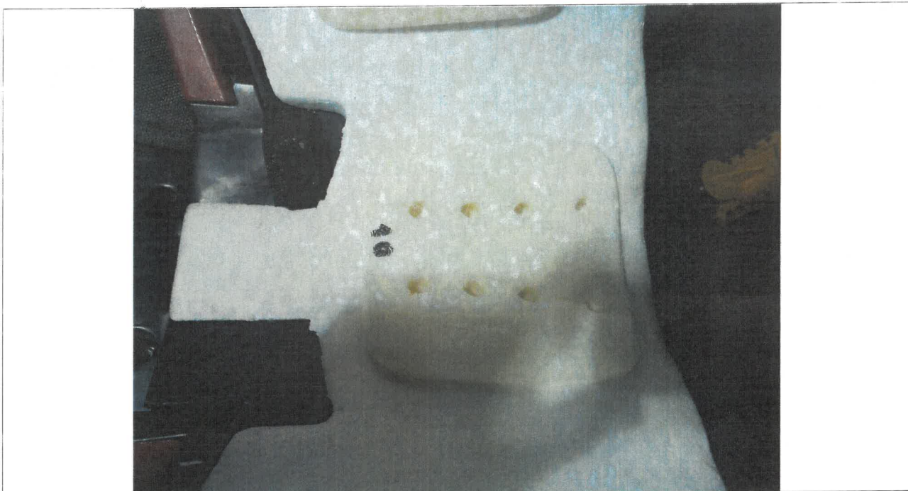
Zdj. 2. Pianka "10" wklejona w zagłówek. Pic. 2. Foam "10" glued to the head restraint.
