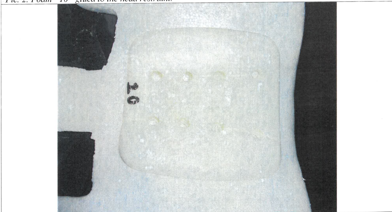
Zdj. 2. Pianka "20" wklejona w zagłówek. Pic. 2. Foam "20" glued to the head restraint.
